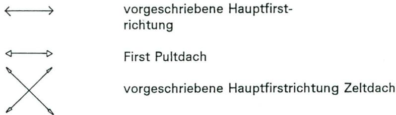
Der First des Hauptbaukörpers bei Satteldächern ist mittig über diesem anzuordnen. Dachüberstände vor Wänden und Stützenkonstruktionen sind mit höchstens 0,70 m in ortsüblicher Bauweise auszubilden.
